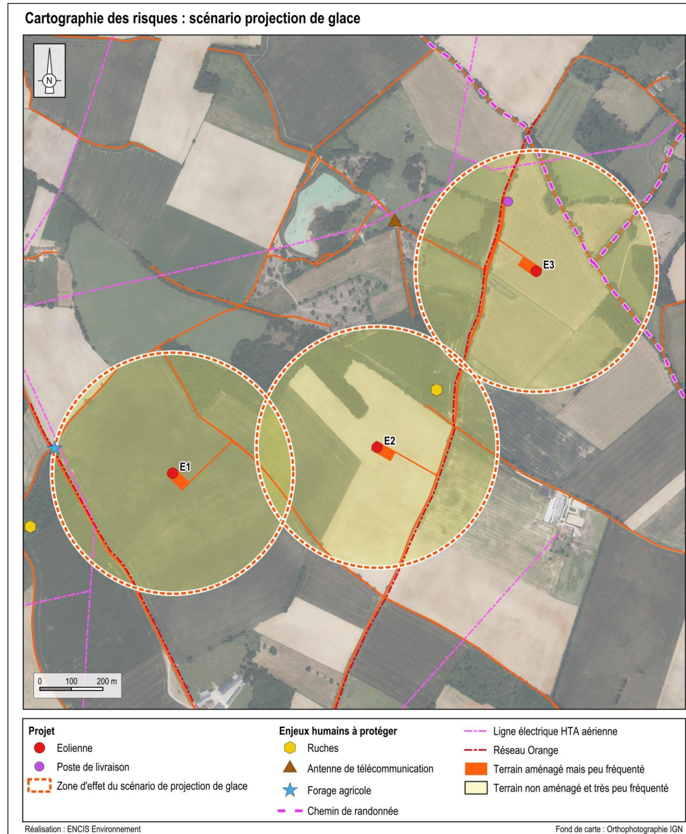
Carte 18 : Cartographie des enjeux identifiés dans les zones d'effet du scénario de projection de glace
